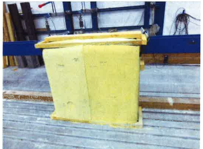
Rien à signaler après les essais M50 / 300 et M50 / 400 Joules sur le remplissage
