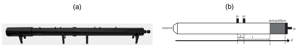
Figure 7-1 : Photographie du tube de Kundt utilisé (a) et schéma de la méthode à trois microphones utilisée (b).
