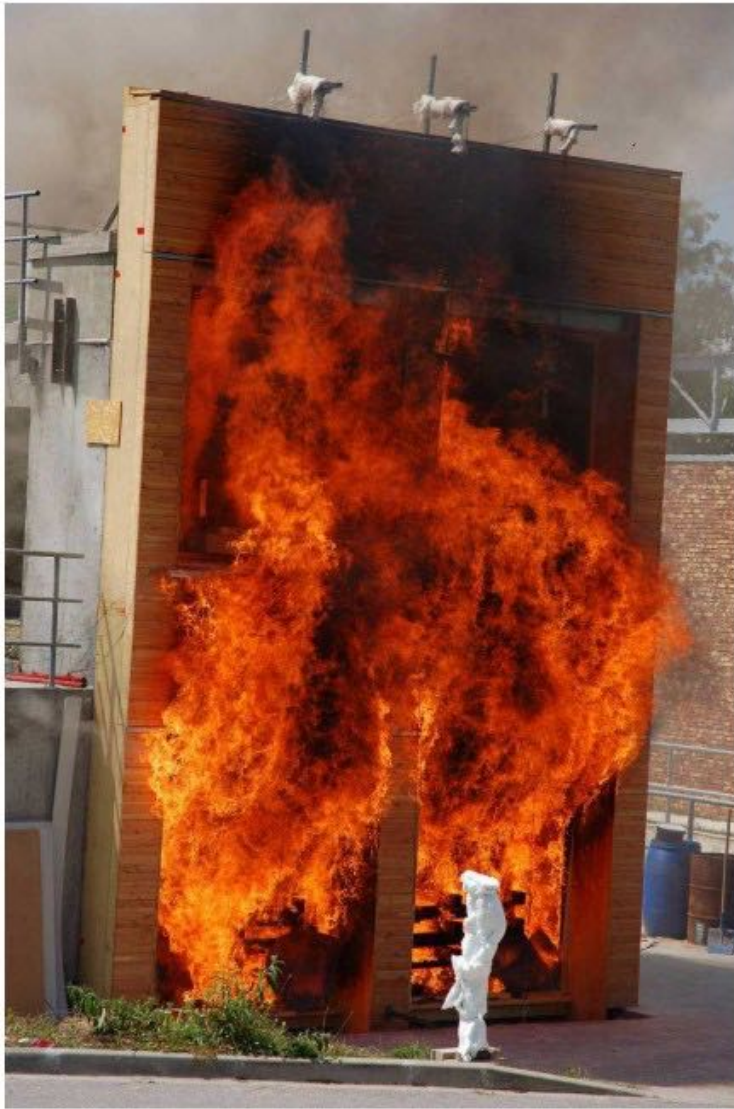
FIRE TEST LEPIR II - 2009
